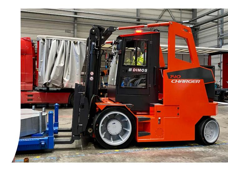
Der Antrieb erfolgt im Standardprogramm rein elektrisch. Im Vergleich zu einem Elektro-Hydrostatischen Antriebskonzept ist der Wirkungsgrad um 30% effektiver.
